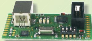
Das **mySmartLab** ist eine Erweiterungsplatine für den USB-Programmer. Damit kann der mySmartUSB per Firmware zum Oszilloskop bzw. Logic Analyzer umgeschaltet werden. Der mySmartLab wird als Bausatz geliefert.
