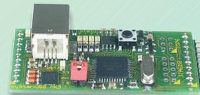
Die kompakteste und kleinste Lösung, um einen embedded Webserver zu realisieren: das **myEthernet**. Visualisieren Sie Messdaten über einen Browser, steuern und regeln Sie über Ihr Ethernet.
