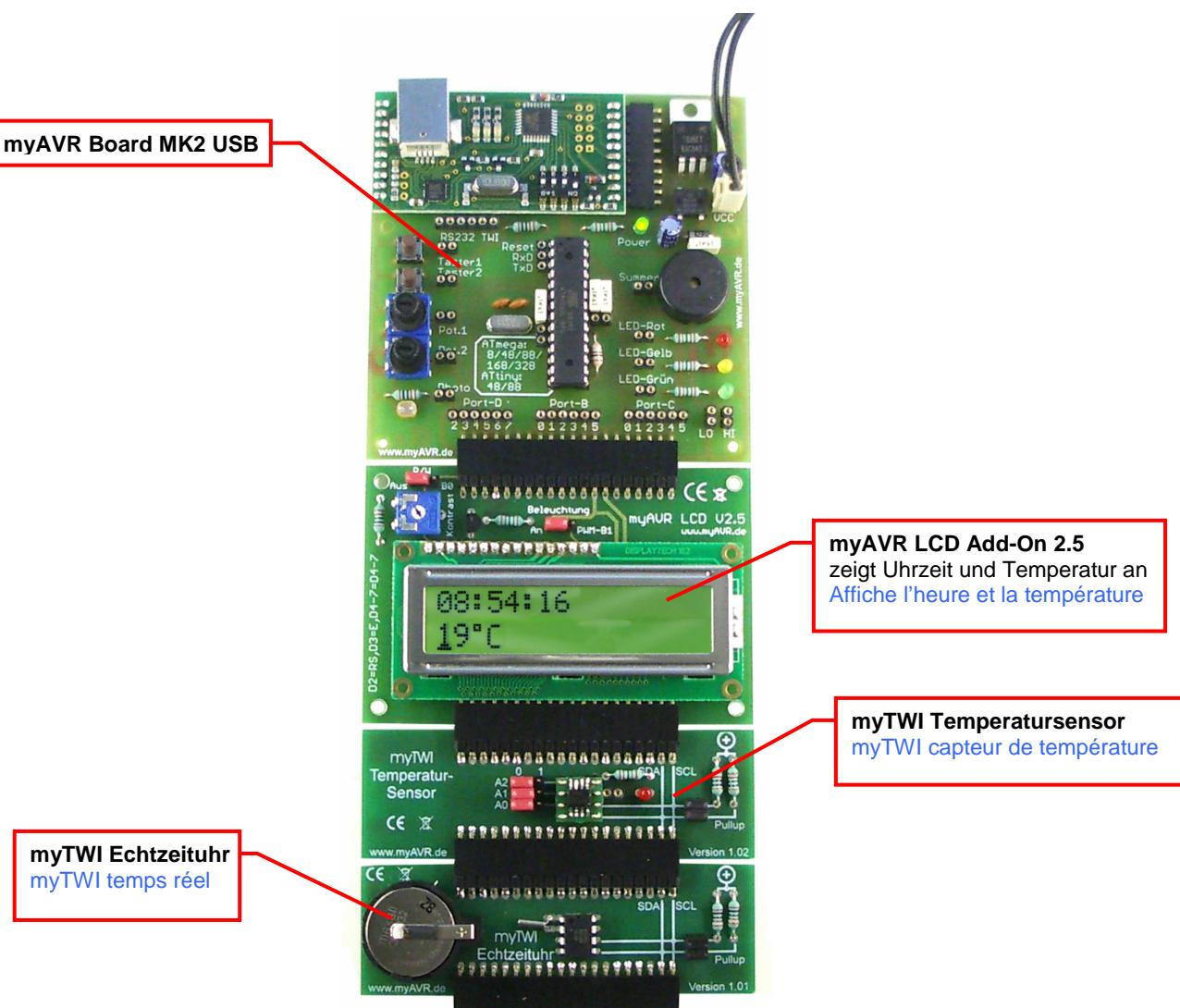
Die Abbildung zeigt das myAVR LCD Add-On an ein myAVR Board USB angeschlossen und erweitert mit:
