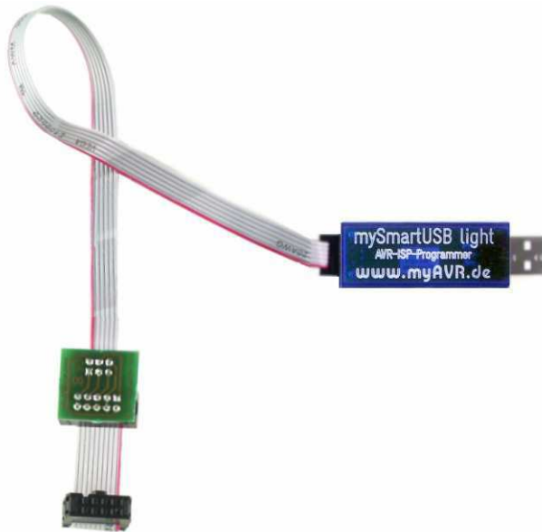
mySmartUSB light mit ISP Connect Kit von 6 auf 10 polig/ mySmartUSB light with ISP connect kit 6 to 10pole
