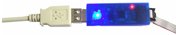
mySmartUSB light mit USB Verlängerung zur Verwendung am PC und ISP Kabel / mySmartUSB light with USB extension to use it at a PC and an ISP cable
