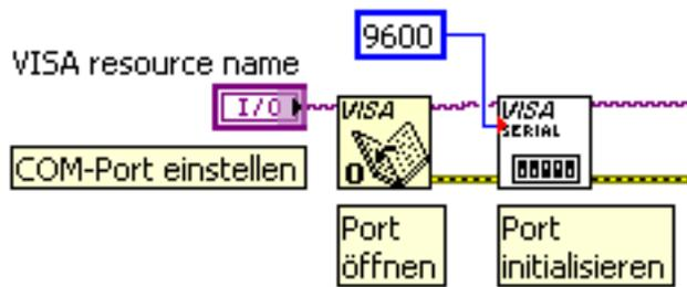
Hier wird der COM-Port geöffnet und die notwendigen Einstellungen festgelegt. Die Baudrate wird auf 9600 gesetzt (für die restlichen Einstellungen werden die Standardwerte übernommen).
