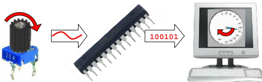
Das Drehen am Potentiometer erzeugt analoge Signale. Es können jedoch nur digitale Signale an den PC gesendet werden. Daher müssen die analogen Daten in digitale umgewandelt werden. Dies macht der A/D-Wandler des Mikrocontrollers. Er wandelt die Signale in den so genannten ADC-Code um.
